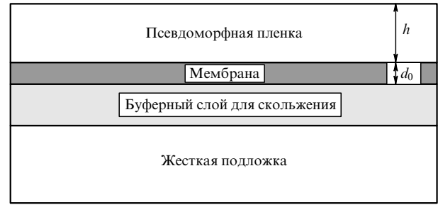
Рис. 16. Схематическая модель гетероструктуры, включающая тонкую мембрану, способную скользить вдоль поддерживающей подложки.
